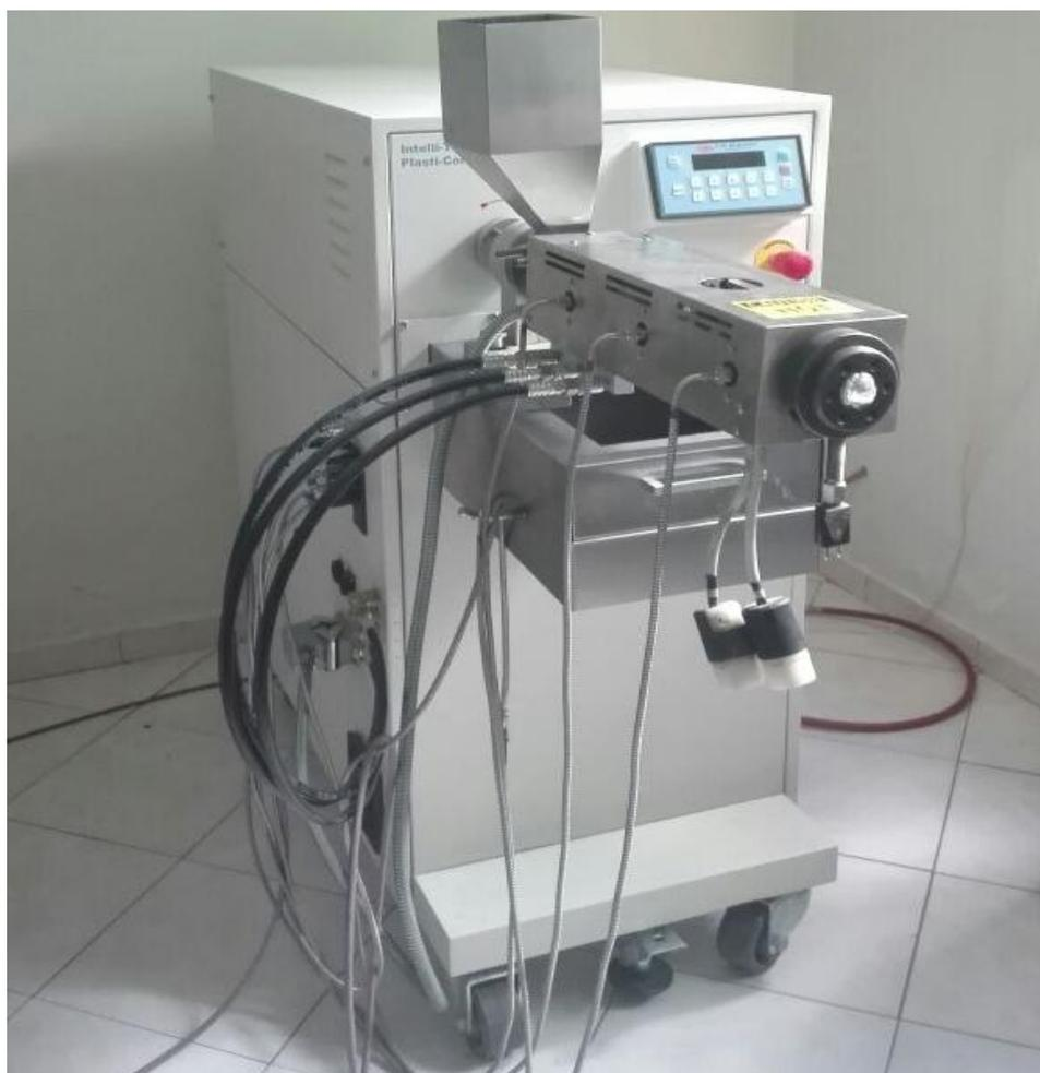
**Figura 11.** Fotografía del extrusor de tornillo simple utilizado.
